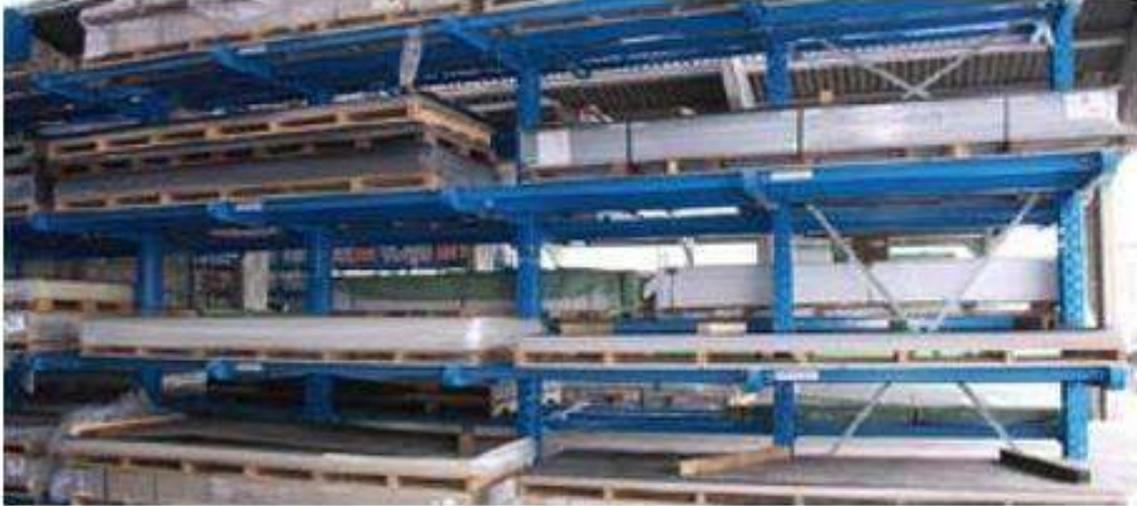
Fig. 3 En el almacenamiento de vidrios y ventanas, es recomendable no apilar más de 20 ventanas
